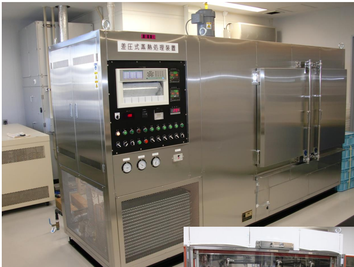
サツマイモの基腐病の試験に使用された蒸熱処理試験装置 (横浜植物防疫所調査研究部) FTH製
