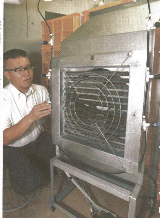
小型化した蒸熱処理装置。イチゴ苗を50度の水蒸気に10分間、当てることで病害虫を大幅に減らす(福岡県筑紫野市で)
